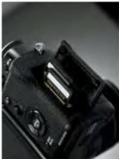
Fig. 24: Las cámaras de doble ranura como la X-T2 pueden funcionar con dos tarjetas de memoria SD al mismo tiempo. Para obtener el máximo rendimiento, debe utilizar tarjetas UHS-II rápidas (como la Sony SF-G con 300 MB/s).
