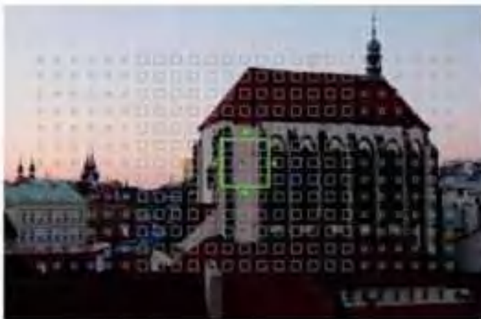
Fig. 133: En muchos modelos de cámaras X (este ejemplo muestra la X-T2), el área del sensor habilitado para PDAF se indica mediante cuadrados más grandes.
